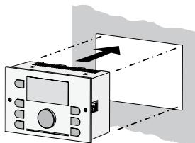
Клеммники TBS-Smile предназначены для подключения эл. проводов к контроллеру в случае, если вы планируете установить контроллер на дверце щита управления или на котловой панели.
