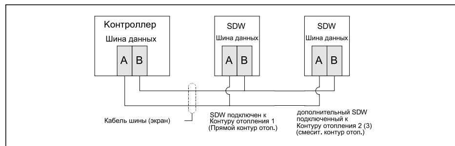
Подключения в контроллере производятся к клеммам BUS A и BUS B.
