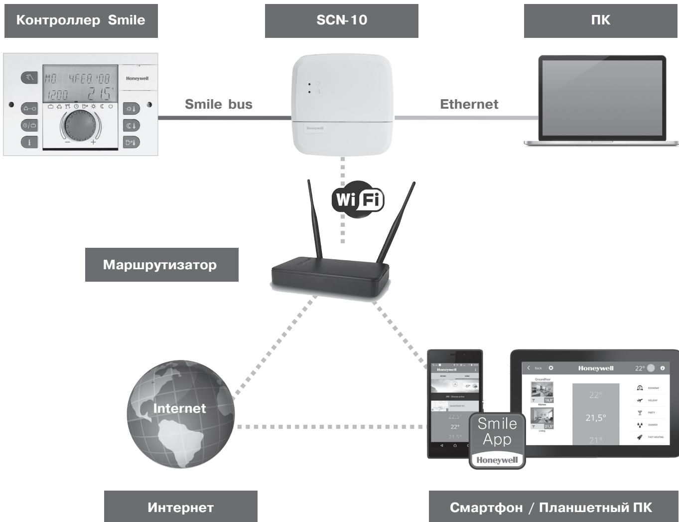
Подключение мобильного устройства к SCN-10 происходит автоматически по одному из двух сценариев.
