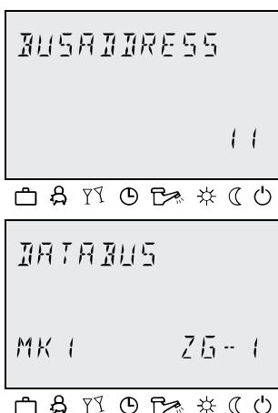
После того, как SDW30N впервые подключен к bus-системе, задается его адрес, учитывая отопительный контур, к которому он относится.
