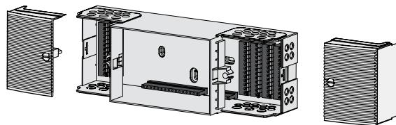
Клеммная коробка имеет подпружиненные клеммы, что существенно упрощает и ускоряет подключение проводов.
