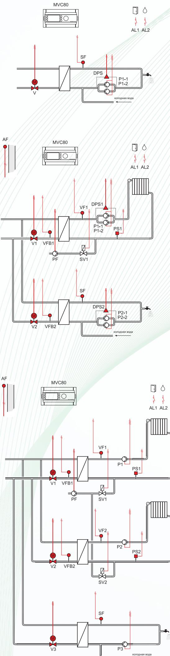
В память контроллера MVC80-DH10 загружены 7 популярных Схем Применения, 6 из которых поддерживают управление как одиночными, так и сдвоенными насосами.
