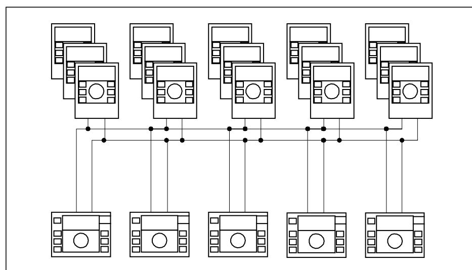
Каждому контроллеру присваивается индивидуальный bus-адрес, который обеспечивает избирательную передачу данных между «основным» контроллером и взаимодействующими «подчиненными» через 2-проводную экранированную шину данных. Каждый «подчиненный» контроллер может самостоятельно передавать данные максимум от трех комнатных модулей (настенных модулей) через назначенный bus-адрес, показанный в таблице:
